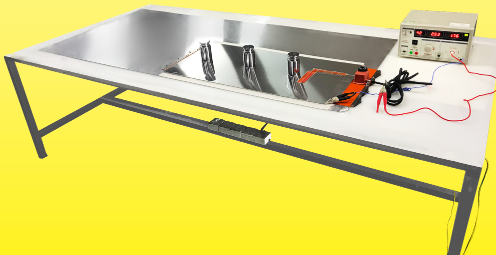
Equipement de mesure du courant de fuite total à froid
